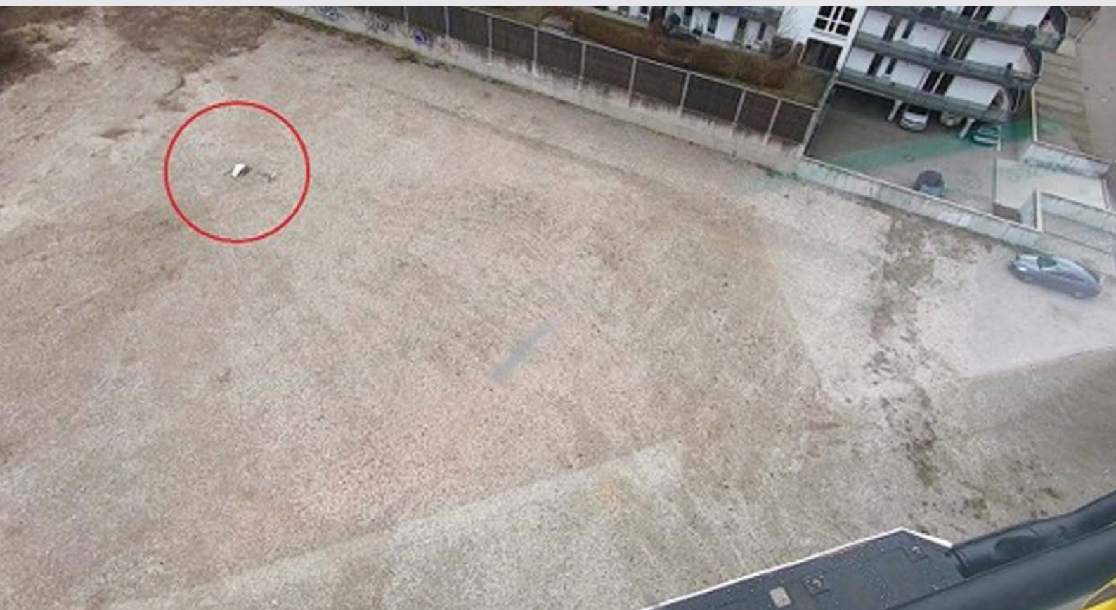
Abb. 3: Eine scheinbar gute Landefläche. Das kleine silbrige Etwas im roten Kreis ist eine Plastikfolie. Eine Gefahr für den Heckrotor!
